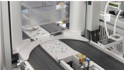
Schleusen mit Umlenkung an den Enden der Förderbänder auf den Stirnseiten der Module
