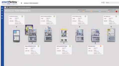
Auswertung aller Informationen aus den Modulen dank einheitlicher IT-Schnittstellen
