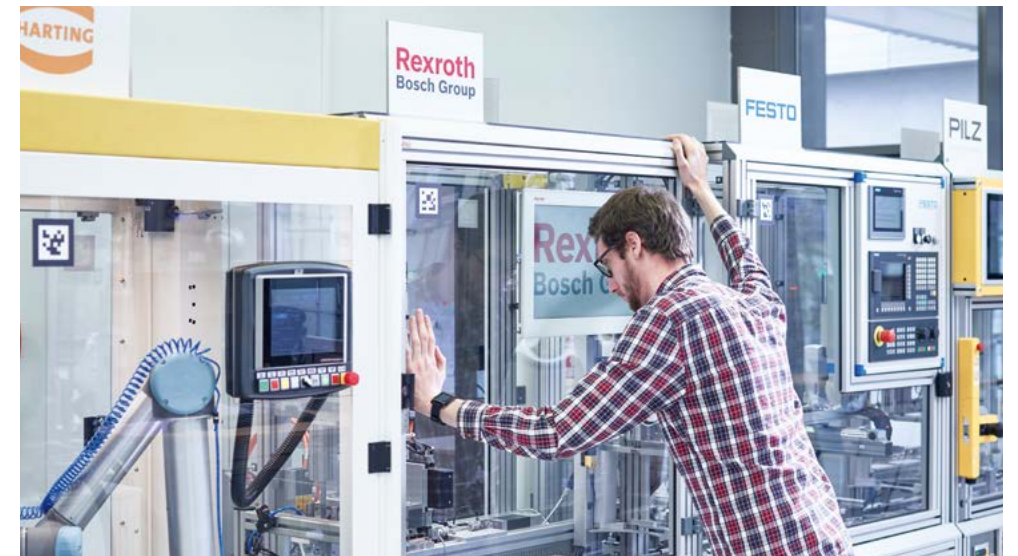
Abbildung 8: Wechsel der Plug'n'Produce- Produktionsmodule an der SmartFactory KL Industrie 4.0- Produktionsanlage
