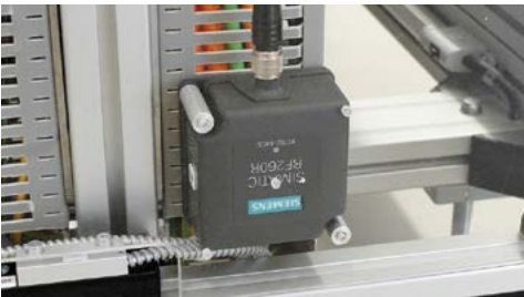
RFID- und Näherungsschalter an der Stirnseite der Module zur Erkennung der Topologie
