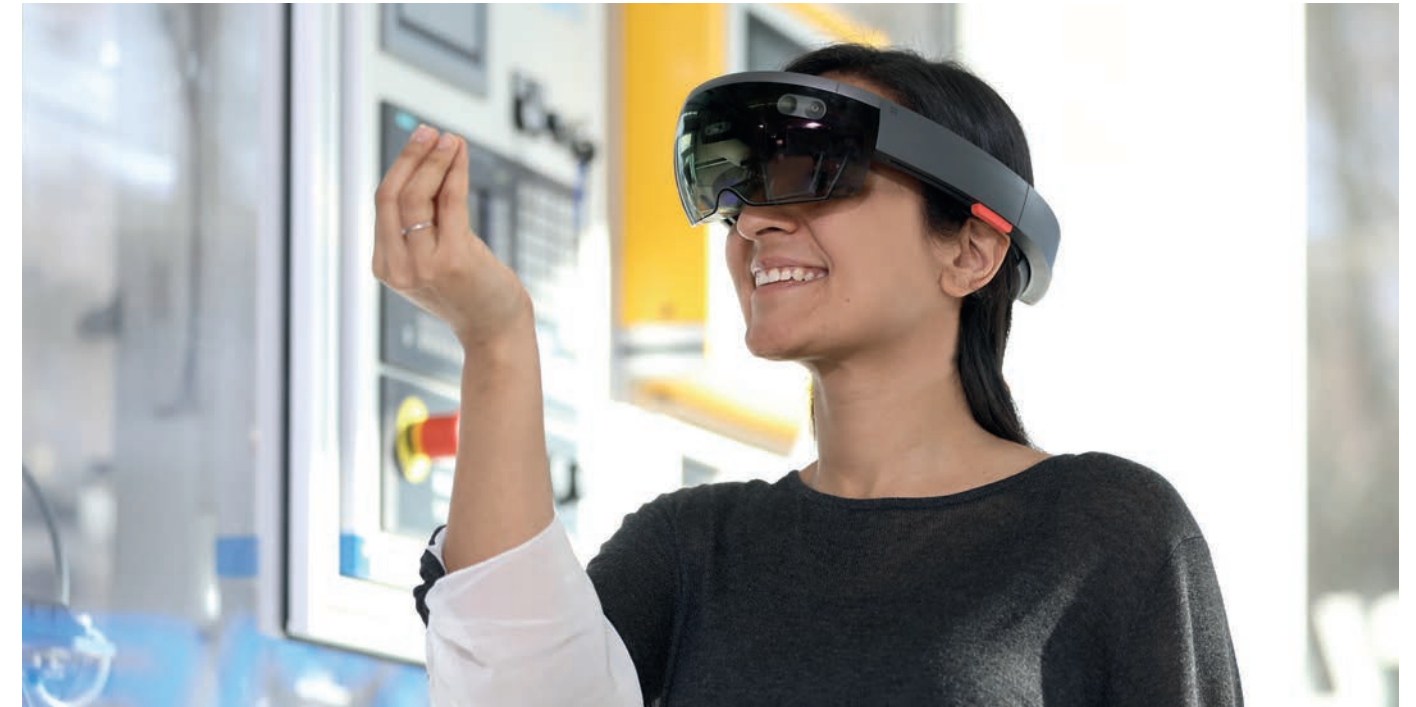
↑ Die Datenbrille unterstützt den Menschen mit projizierten Arbeitsanweisungen.
